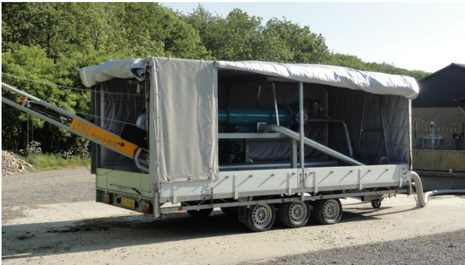
BÖRGER BIOSELECT BC50 ANLÆGGET ER MONTERET PÅ EN TREKSLT TRAILER MED ISOLERET PRESENNING.
