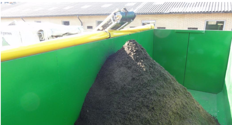
FIBEREN LEVERS VIA ET TRANSPORTBÅND I EN AF DE TO TILHØRENDE CONTAINERE, OG TRANSPORTERES DEREFTER TIL BIOKRAFT.
