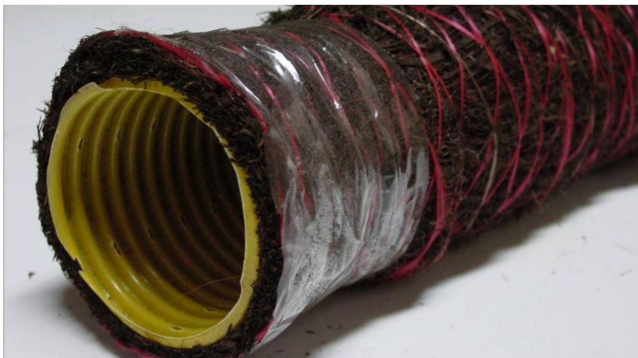
PERFOREREDE PVC SLANGER SOM DISSE, PLACERET I MARKERNE I 80-120 CM'S DYBDE, ANVENDES OFTE TIL DRÆNING.
