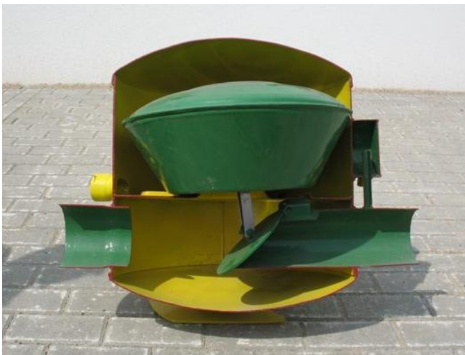
REGULERINGSENHED TIL ON/OFF DRÆNING, UDVIKLET I DET TIDLIGERE ØSTTYSKLAND I 1989.
