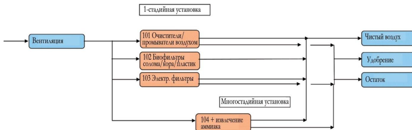
Рисунок 10: на рисунке представлены технологии переработки воздухом. Их основная цель – улавливание испаряющегося аммиака, а также уменьшение неприятного запаха. Настоящий проект на них не фокусируется.
